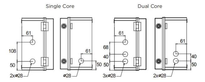
Drilling Guide for 1" Conduit
